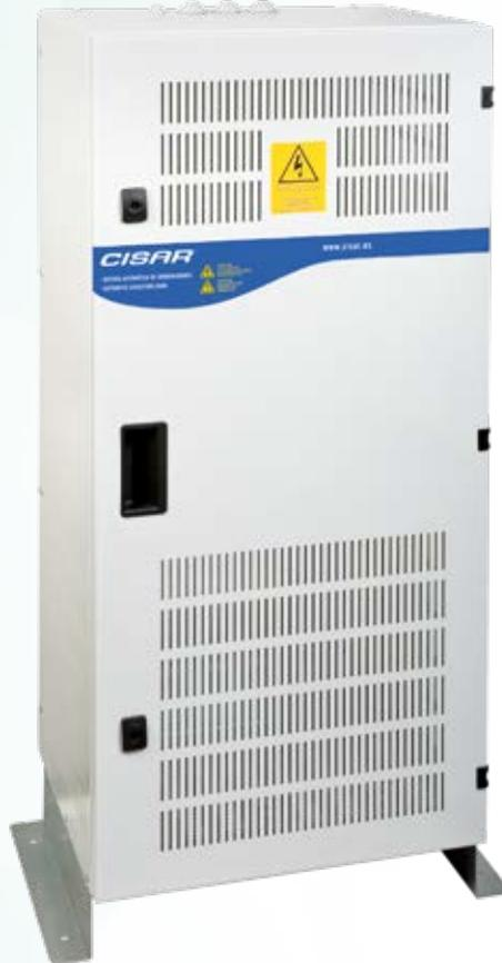
Condensador Fijo con inductancia de rechazo armónico. Inductancia sintonizada a 189Hz, de bajas pérdidas y que soporta valores de THDu de hasta el 6%. Condensador RDC reforzado a 480V con tecnología MKK. Disponible con protección Fusible o Automático de Alto Poder de Corte.
