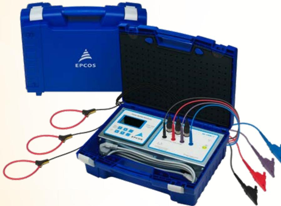
El analizador de redes portátil MC7000-3 ha sido especialmente diseñado para la medición en redes trifásicas en baja tensión. Montado en una compacta y liviana maleta, cuenta con un display gráfico el cual puede mostrar varias vistas simultáneamente en varias ventanas gráficas para una fácil y rápida visualización de las medidas. Los datos recogidos son almacenados en una tarjeta SD, disponiendo de ellos en formato Excel facilitando el trabajo posterior. Además incluye el software MC-7000 SOFT.
