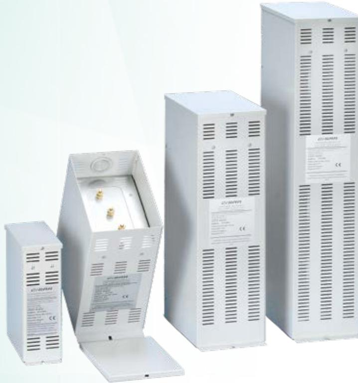
Condensador Trifásico en caja prismática de IP 31. Las características del condensador son las mismas que los CRM y CRT. No incluyen ningún tipo de protección adicional, y la conexión se realiza sobre unos bornes de latón. Incluye las resistencias de descarga.
