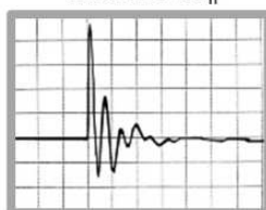
Conexión sin resistencias hasta 250 \times I_n
