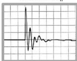
Conexión sin resistencias hasta 250 \times I_n
