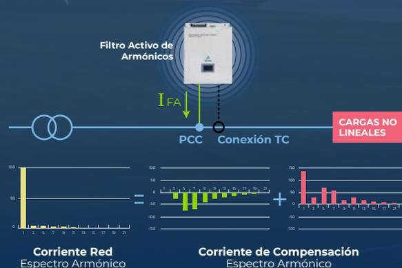
El Filtro Activo de Armónicos genera e inyecta una señal de la misma amplitud, pero a contrafase a la instalación para de esta manera compensar la corriente armónica existente.
